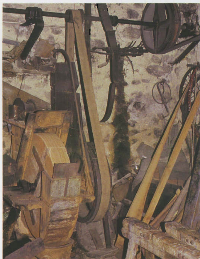
▲ La meule en grès naturel, pour la finition, l'affûtage des pièces ou des outils.
