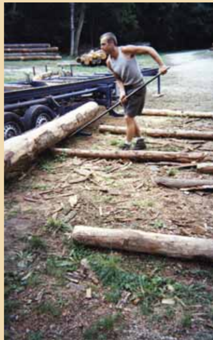
▲ Le placement de la bille sur le lit de sciage : habileté et force sont requises
